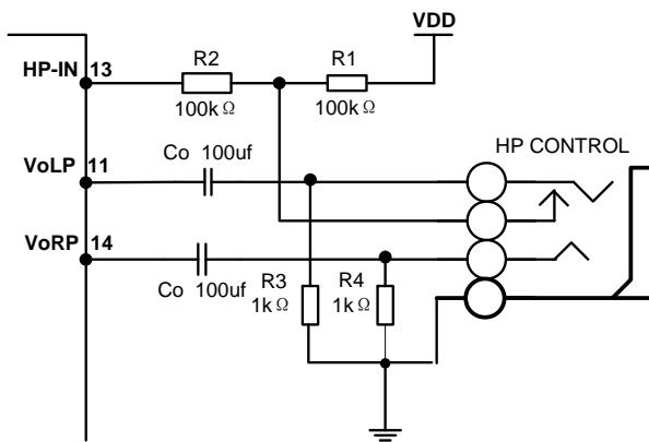
图4 立体耳机工作电路示意图
