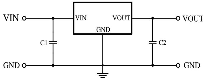
**注意：**1、一般而言，线性稳压电源因选择外接零件的不同有可能引起振荡。上述电容器使用前请确认在应用电路上不发生振荡。
