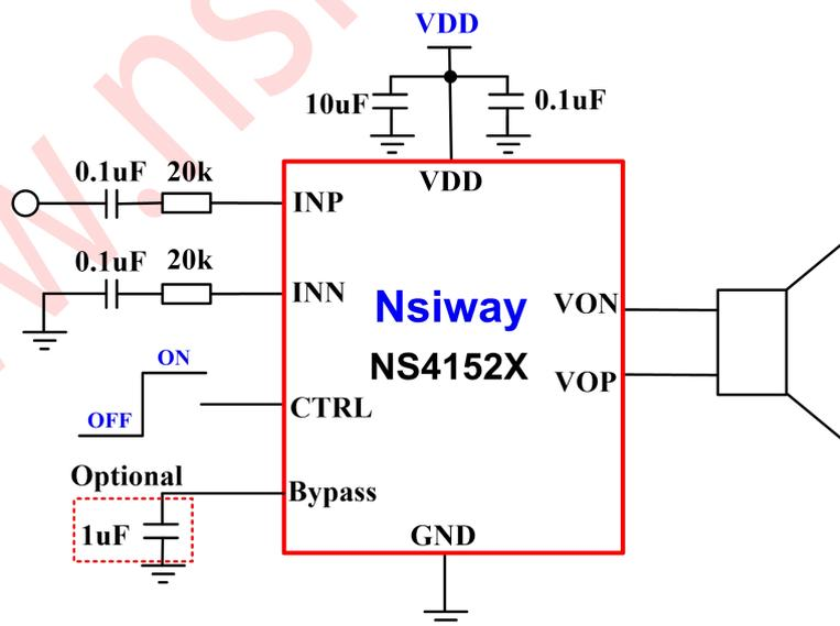
注：常规应用中 Bypass 引脚电容可以不加。但考虑部分应用场景中存在高频噪音影响，建议 Layout 时预留此电容位置。
