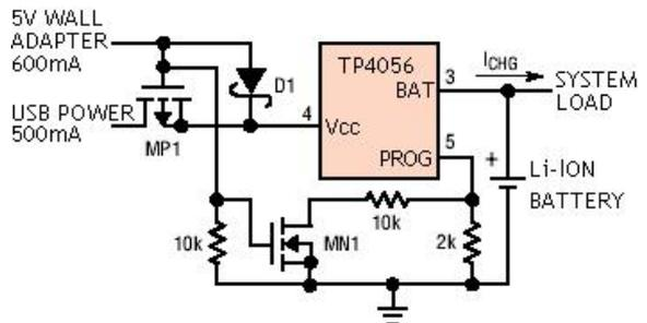
图 6: 交流适配器与 USB 电源的组合
