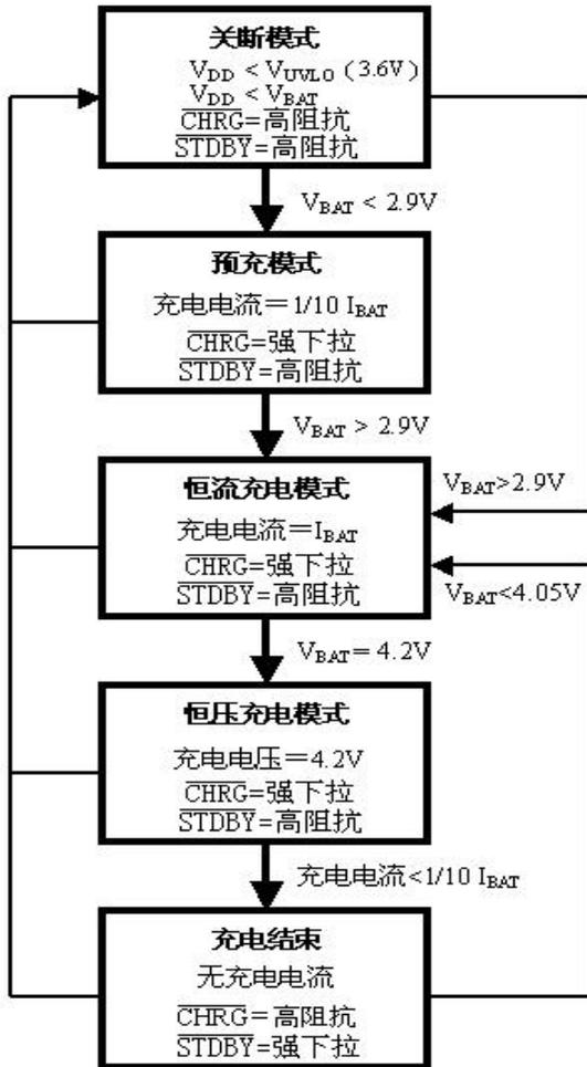
图 1：一个典型充电循环的状态图
