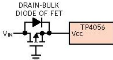
图 5: 低损耗输入反向极性保护
