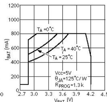
充电电流与电源电压的关系曲线
